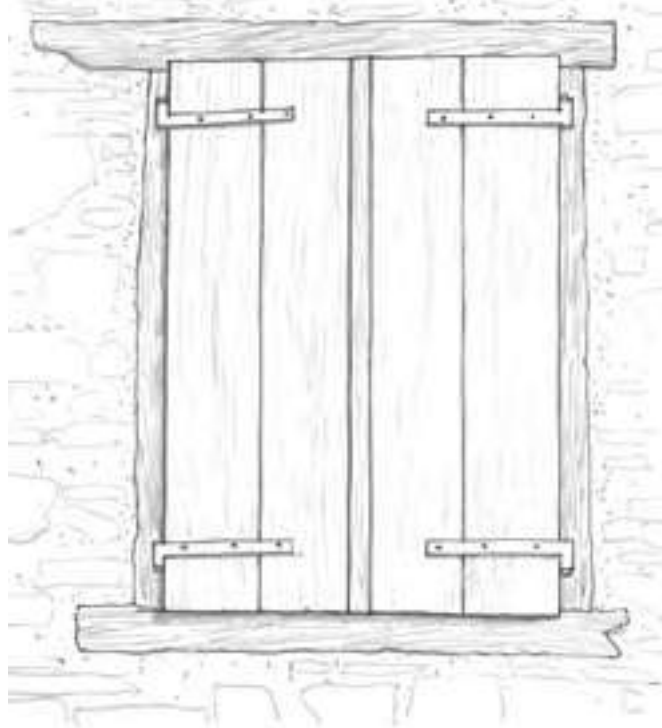
Fenêtre à encadrement en bois. Jambages, appui et linteau en bois. Volets en planches verticales.
