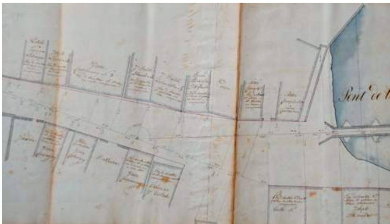
Plan d'alignements 1820, les maisons font l'objet de servitudes d'alignement pour créer un front bâti rectiligne. Oloron Sainte-Marie.
