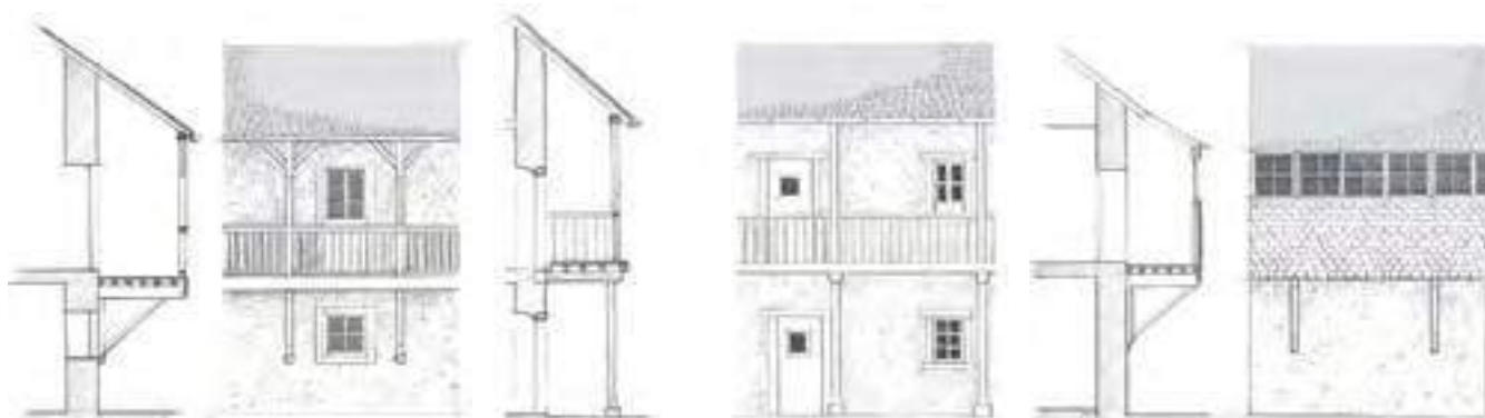
Galerie ouverte sur consoles.
