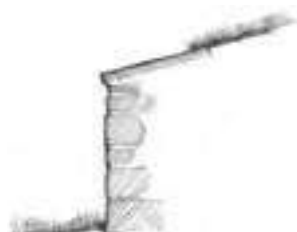
Mur de soutènement en pierre, couronnement en dalle schiste inclinée pour favoriser l'écoulement de l'eau.
