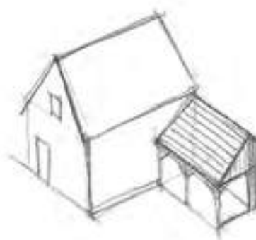
Abri léger orthogonal au bâti principal
